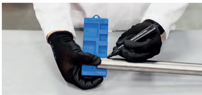
Obrázek 30 – Označení hloubky zasunutí
