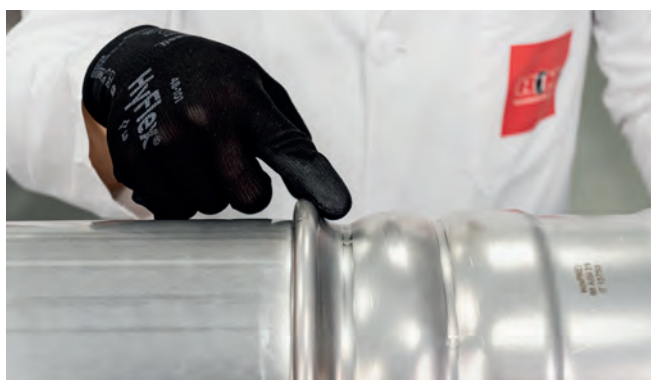
Obrázek 41 – Vizuální kontrola slisování velkých rozměrů
